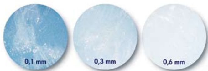
3. Luminosité différente en fonction de l'épaisseur de composite.
